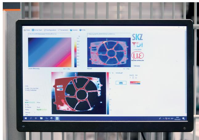
**Bild 2.** Alle Lüfterzargen werden nach der Entnahme zu 100% QS-geprüft
